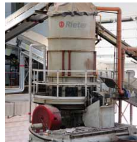
Příprava pro lisování: Směs, ze které se mají vylisovat cihly, musí mít správnou vlhkost, která se jí musí před vstupem do lisu dodat. Pokud by do lisu vstoupila směs příliš tuhá, nebylo by možné výrobky lisovat.
