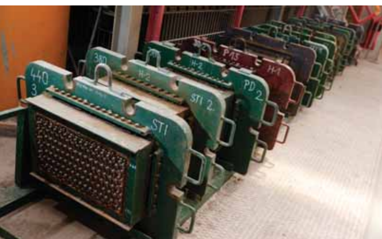
Forma: Základem know-how celé výroby jsou formy. Ve společnosti HELUZ si formy vyrábějí sami a dokážou vyrobit cihlu se stěnou tenkou až 4 mm! Aktuálně zde používají kolem 80 typů forem.
