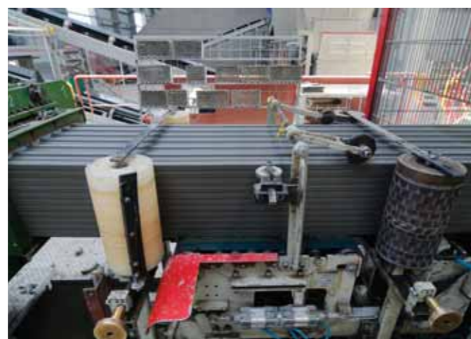
Ústí lisu: Ve formě jsou zabudovaná jádra, která vytvoří v cihle známé dutiny. Surovina se protlačuje formou, podobně jako v mlýnku na maso, pod tlakem kolem 19 barů. Výsledkem je dlouhý spojitý tvar.
