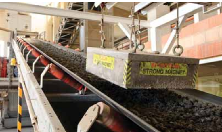
Magnet: Na pásu jsou umístěny magnety, které hlídají, aby ve směsi nezůstaly žádné případné kovové předměty, které by později mohly napáchat velké škody ve výrobě. Pokud nějaký takový železný předmět magnet nalezne, automaticky se zapne odpadový pás a železo se vyhodí na hromadu, kde ho obsluha najde a odstraní.
