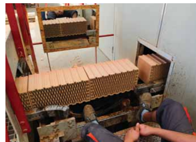
Výstup z brusky: Vypálené cihly se ještě musí zbrusit na finální rozměr. Pro zděnění na lepidlo musí mít přesnou výšku 249 ± 1 mm (pro maltu není potřeba). Po vypálení mají cihly již svoji charakteristickou červenou barvu, jejíž odstín se liší mimo jiné i obsahem železa v dané surovině. A kolik cihel zde vlastně vyrobí? Za 20 hodin opustí výrobní linku kolem 50 tisíc kusů.
